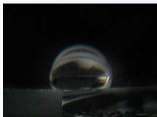
第16组a (小花) 衬底:玻璃 接触角 120^{\circ}
