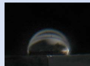
第14组b2 (棒+小花) 衬底:玻璃 接触角 110^{\circ}
